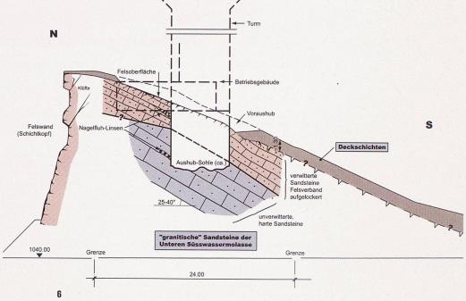
Geologisches Profil ca. 1:400 durch den Kamm der Höhronen mit Turmfundament
