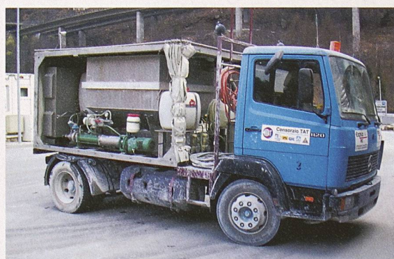
2 Sprengmobil in Faido mit Misch- und Ladeeinheit (Bilder: Zschokke Bau AG)
