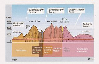
Geologischer Längsschnitt AlpTransit-Gotthardbasistunnel (Bild: AlpTransit)
