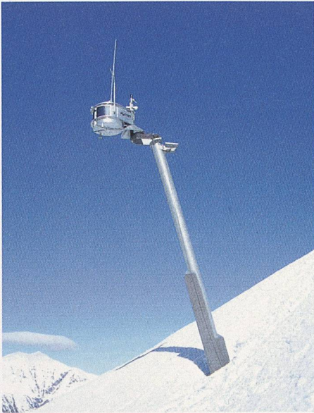
Ortsfeste Lawinensprenganlage: Sprengmast Wyssen auf der Engstligenalp bei Adelboden. Die Ladung wird an einem Seil vom Magazinkasten abgeworfen und detoniert über der Schneedecke (Bild: Wyssen Seilbahnen)
