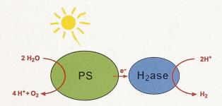
Umweltfreundliche Wasserstofferzeugung: schematisiertes biomimetisches Modell, in dem Hydrogenasen (H<sub>2</sub>ase) an die fotosyntethische Wasserspaltung (PS) gekoppelt werden. Sonnenenergie soll die Wasserstofferzeugung antreiben (Bild: Ruhr-Universität Bochum)
