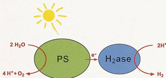
**Umweltfreundliche Wasserstofferzeugung: schematisiertes biomimetisches Modell, in dem Hydrogenasen (H<sub>2</sub>ase) an die fotosynthetische Wasserspaltung (PS) gekoppelt werden. Sonnenenergie soll die Wasserstofferzeugung antreiben (Bild: Ruhr-Universität Bochum)**
