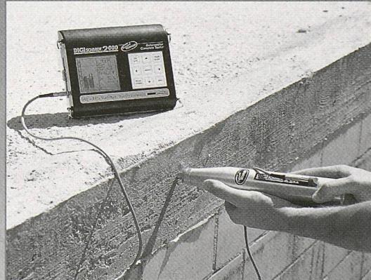
**DIGI-SCHMIDT 2000** von Proceq ist ein Betonprüfhammer, der – mit einem Sensor ausgerüstet – die Messwerte speichert und auswertet.
