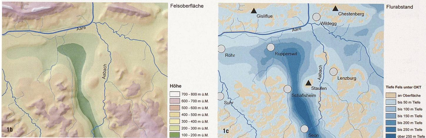
also zu einer Oberfläche zusammenfügen lassen, die hydrologischen Prinzipien entspricht. Hier kommen Raster-GIS-Werkzeuge zum Einsatz. Sie erlauben auch die Modellierung isolierter Senken, wie sie z.B. in Karstgebieten oder durch die Tiefenerosion von Gletschern auftreten (Bild 1). Auchablagerungsgeschichtlich komplexere Situationen (z.B. Erosion an den Hängen bei gleichzeitiger Aufschüttung in der Talaue) können bei Vorliegen entsprechender Daten einfach nachgebildet werden.
