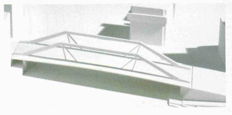
Auf die notwendigsten Elemente reduziertes Rahmen-Hängewerk in Stahl
