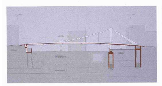
Das Gewicht der leichten Fahrbahn über den Gleisen wird durch den massiv ausgeführten Teil auf der rechten Seite teilweise ausbalanciert (1. Preis, Dobler, Schällibaum; André Rotzetter; Feddersen+Klostermann)
