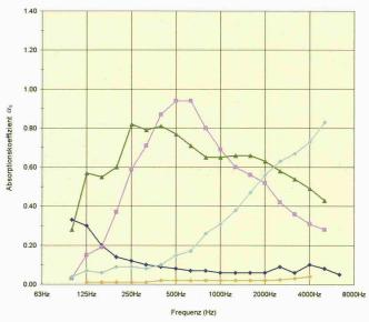
Vergleich der frequenzabhängigen Schallabsorptionskoeffizienten  $\alpha_{\rm s}$  von typischen Baumaterialien:
