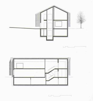
7 Quer- und Längsschnitt mit Erschliessungskern und tragender Wandscheibe als Installations-«Schacht». Mst. 1:500
