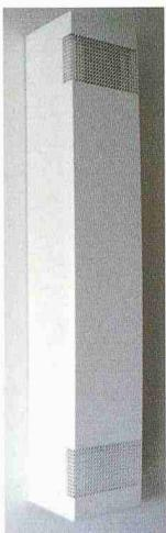
Lösung das Einzelraumgerät an. Zwei Bohrungen durch die Außenwand und ein Elektroanschluss genügen. Auch wenn nur einzelne Räume belüftet werden sollen, zum Beispiel lärmbelastete Schlafzimmer oder Sitzungszimmer, eignet sich das Einzelraumgerät optimal. Laut der Firma Fraefel Ökotechnik weist das Gerät gute technische Daten auf: elektrische Leistungsaufnahme nur 3W, Wärmerückgewinnungs-Wirkungsgrad über 80 %, elektro-thermische Verstärkung über 30fach.
