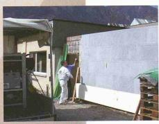
Nachdem die Testwand über Wochen der Witterung ausgesetzt war, wurden die Ergebnisse im Labor ausgewertet. Erst jetzt konnte die Baustellentauglichkeit der Fassadendämmplatte Lambdapor Progress an Objekten mit dicker Dämmung getestet werden.
