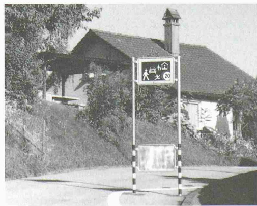
In Begegnungszonen wie hier am Löchligutweg in Bern gilt «Tempo 20», und die Fussgänger dürfen die ganze Fahrbahn benützen (Bild: Stadtplanungsamt Bern)
