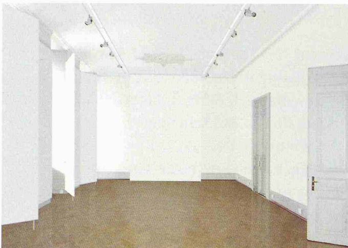
Ehemaliger Unionssaal: Die geschlossenen Flügel zwischen den Fenstern vergrössern die Wandfläche, geöffnet entstehen Nischen (Entwurf der Architekturmuseums-Räume: Peter Märkli; Bild: Architekturmuseum)
