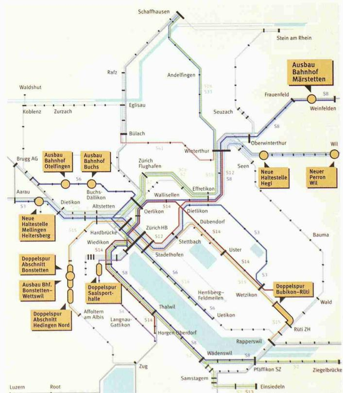
Mit dem Tiefbahnhof Löwenstrasse (unten, rechts der Mitte) erhält der Hauptbahnhof in Zürich 4 zusätzliche Durchgangsleise. Der neue Weinbergtunnel (gestrichelt) wird eine weitere Verbindung nach Oerlikon schaffen (Bild: SBB)
