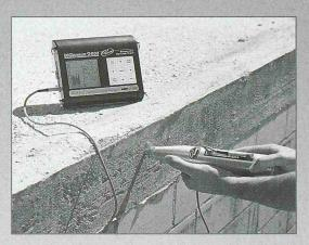
**DIGI-SCHMIDT 2000** von PROCEQ ist ein Betonprüfhammer, der – mit einem Sensor ausgerüstet – die Messwerte speichert und auswertet.
