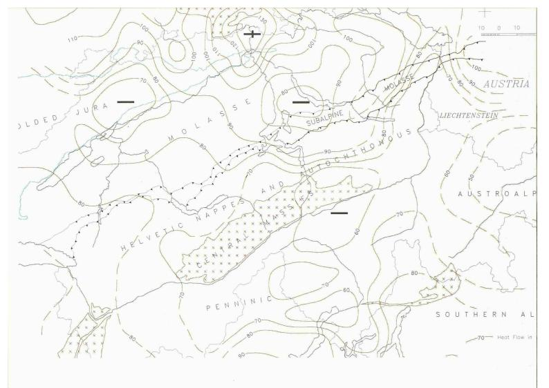
Erdwärmenutzung mit Wärmepumpen ist überall möglich. Dies gilt allerdings nicht unbedingt für die rein geothermische Nutzung in Tiefen über 1km. Die Schweizer Karte zeigt Bereiche mit unterschiedlichen natürlichen Wärmeflüssen ([mW/m²], rotbraune Linien), die insbesondere im Aargau besonders ausgeprägt sind. Der Wärmefluss charakterisiert den Energiefluss, der in der Regel auch proportional zur Temperatur ist (Bild: Institut für Geophysik, ETH Zürich)
