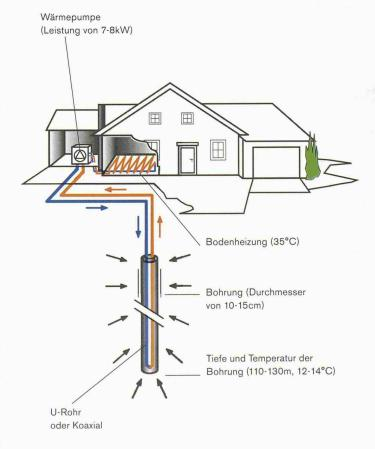
In der Schweiz wird heute in fast jedem zweiten neuen Einfamilienhaus eine Wärmepumpe installiert, in etwa der Hälfte der Fälle wird zusätzlich noch eine Erdwärmesonde eingebaut (Bild: Schweizerische Vereinigung für Geothermie)
