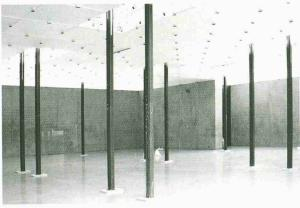
Belastungsprobe für das Kunsthaus Bregenz: «300 tons» von Santiago Sierra. Das Gewicht von 14 600 im obersten Geschoss zu Kuben gestapelten Betonsteinen wird in den Etagen darunter von Stützen abgetragen (Bilder: pd)
