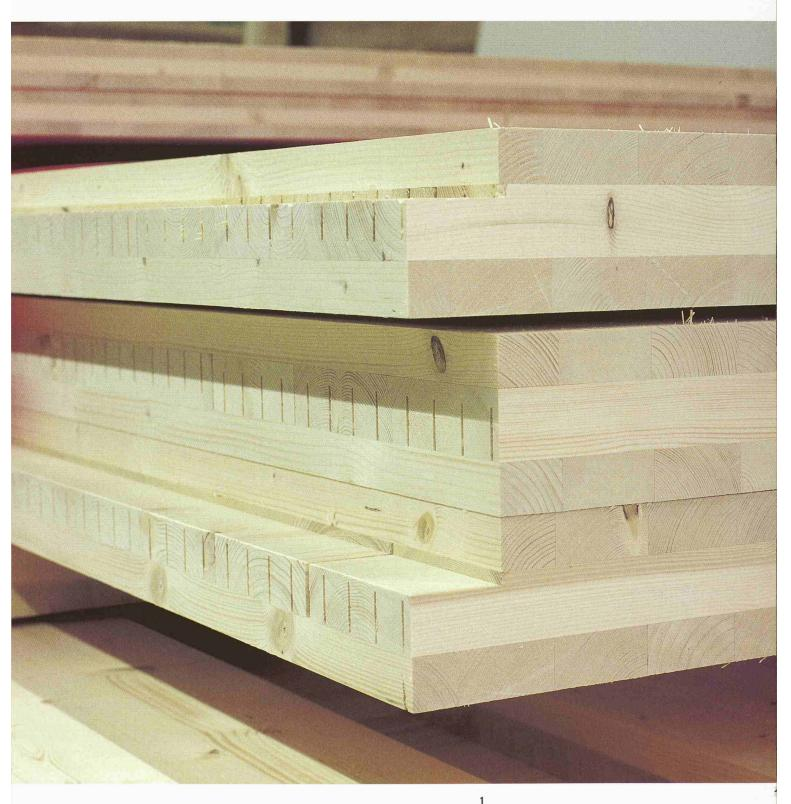
Dreilagige Massivholzplatten im Sägewerk. Auf computergesteuerten Maschinen werden Nuten, Löcher und Öffnungen ausgefräst (Bild: Hannes Henz)
