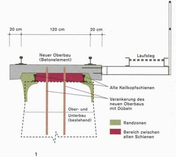
Querschnitt des Trassees im Dammbereich gemäss Projektvorschlag. Zwischen der zuerst versetzten, mit Dübeln verankerten vorgefertigten neuen Fahrbahnplatte und dem bestehenden Oberbau entstand ein langer und enger Hohlraum. Dieser wurde sowohl zwischen den auf dem alten Oberbau belassenen Keilkopfschienen (roter Bereich) als auch in den abgeschalten Randbereichen (grün) mit frostbeständigem SCC verfüllt (Bilder: Holcim [Schweiz] AG)
