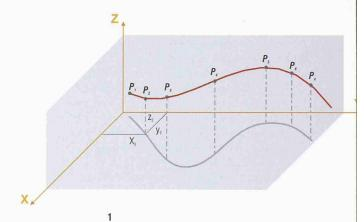
Schematische Darstellung der Beschreibung der Gleisgeometrie  $(P_1-P_n)$  in einem georeferenzierten Koordinatensystem (X, Y, Z) mit den Landeskoordinaten als Basis (Bilder: SBB)
