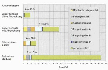
5 Anwendungen für Sekundärbaustoffe und Anteil der Sekundärbaustoffe in den Anwendungen (A = Sekundärbaustoffe in einer Anwendung / total kiesige Materialien in der Anwendung; im Kasten: A, B und P sind Qualitätskategorien von Recyclingkies nach Buwal)
