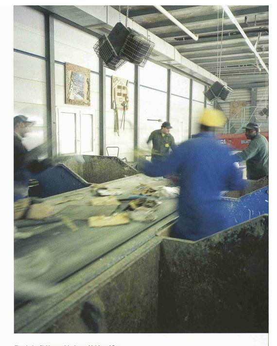
Eine riesige Siebtrommel (unten rechts) trennt Bauschutt nach der Grösse: Was kleiner als 40 mm ist, gelangt in ein Rüttelsieb (unten links), was 40–200 mm gross ist, kommt in den Magnetabscheider. Der Bauschutt, der die Siebtrommel verlässt, zieht auf der Handlesestrecke an Arbeitern vorbei (oben). Diese trennen Holz, Metall und Gips vom übrig gebliebenen Bauschutt. Dieses Material wird später rezykliert. Brennbares gelangt in die KVA, Mischabbruch bleibt auf dem Förderband
