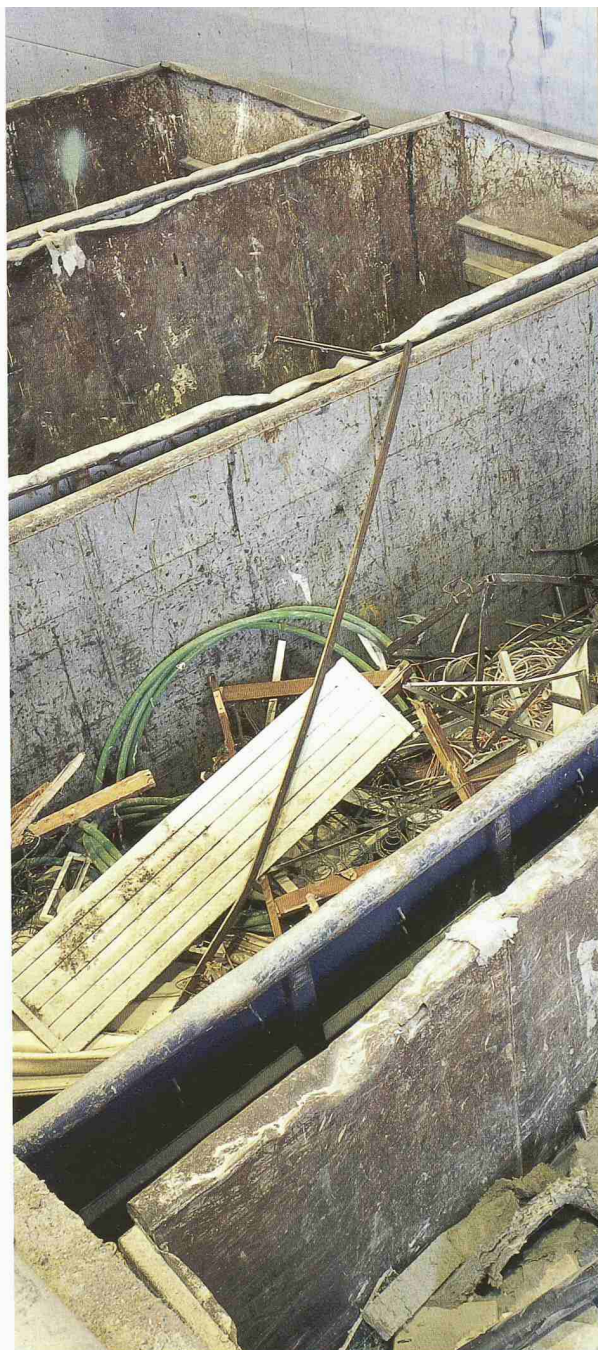
Mit dem Bagger werden Holz, Metall und grober Bauschutt für das spätere Recycling voneinander getrennt (oben), nur Brennbares wird der Kehrichtverbrennungsanlage (KVA) zugeführt. Was nicht mittels Bagger trennbar ist, gelangt via Förderband in den eigentlichen Sortierprozess (unten). Absiebung und Handlese sind die weiteren Schritte. Diverse Anlagen, die seltsam anmutende Namen wie Rüttelsieb, Magnetabscheider und Windsichtung tragen, reduzieren die Handarbeit auf ein Minimum (Bilder: Michael Lio)
