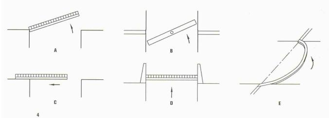
Die fünf Grundarten beweglicher Brücken: A Zugbrücke, B Drehbrücke, C Einzug- oder Teleskopbrücke, D Hebebrücke, E Gateshead Millennium Bridge (Bild: Gifford and Partners)
