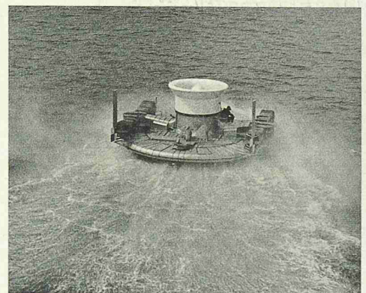
Bild 1. SRN-1 Hovercraft von Saunders-Roe bei einer Fahrt über Wasser. Als unerwünschte Begleiterscheinung äussert sich dabei der das Fahrzeug umhüllende Sprühregen
