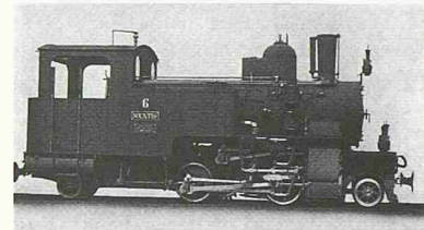
Lokomotive Nr. 6, «Säntis», der St.Gallen-Gais-Appenzell-Bahn mit getrennten Triebwerken für Adhäsions- und Zahnstangenantrieb System «Winterthur», ca. 1905. (Bilder aus: Eidg. Amt für Verkehr [Hrsg.]: «Ein Jahrhundert Schweizer Bahnen 1847-1947», Bd. 5, Bern 1964)
