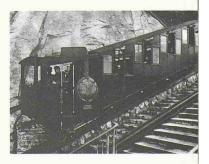
Dampftriebwagen der 1889 eröffneten Pilatusbahn mit horizontal gelagerter Doppelzahnstange System Locher träge von Professor Fliegner. Oberingenieur
