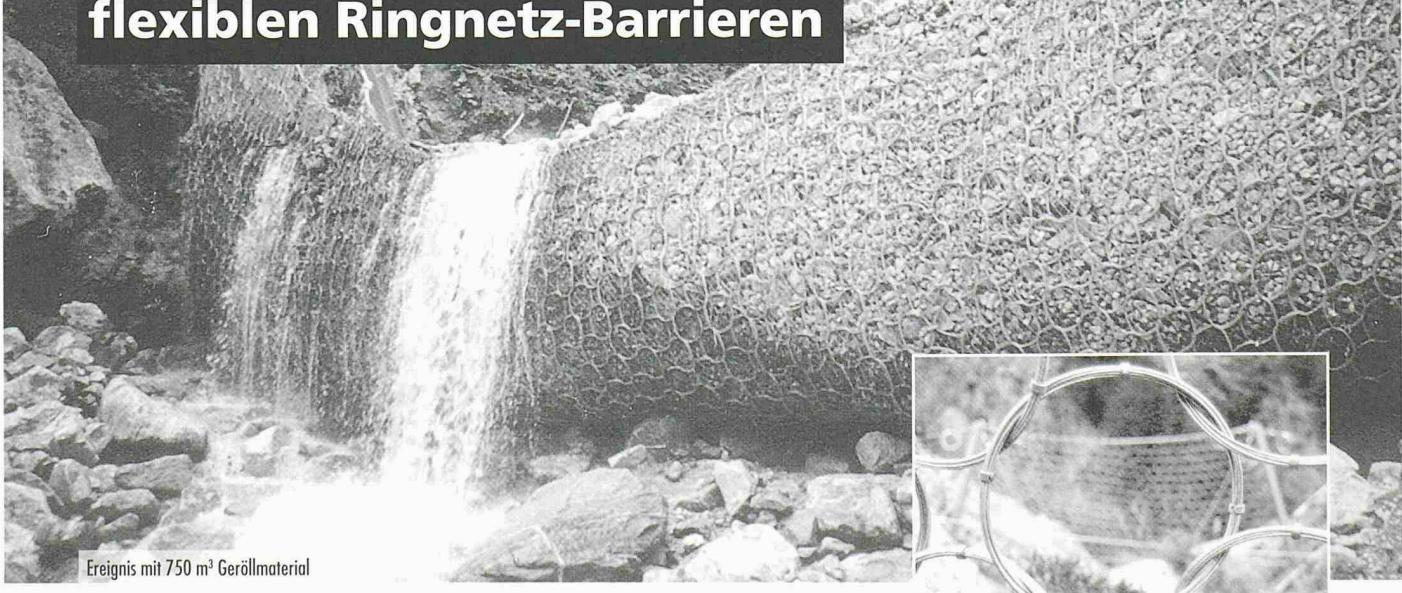
Geröllmaterial von bis zu 1'000 m<sup>3</sup> kann durch flexible ROCCO® Ringnetz-Barrieren gestoppt werden. Ihre leichte Bauweise erlaubt eine einfache und kostengünstige Installation. Die filigranen Ringnetz-Barrieren, bemessen für dynamische Aufschläge, sind eine echte Alternative zu massiven Beton- und Stahlbauten.
