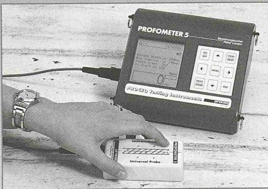
**PROFOMETER 5** von PROCEQ ist ein besonders leichtes, kompaktes und tragbares Gerät. Es ortet Bewehrungsstäbe, misst Betondeckungen und Stabdurchmesser – schnell, präzise und einfach.
