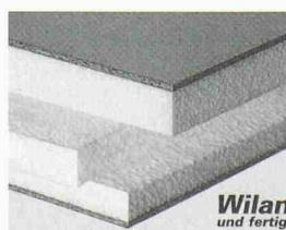
Isolationselemente **beidseitig** belegt mit schlagfesten und hochdurchreinigerfesten Deckschichten, z.B. aus weißbeschichteten Dünnspan- oder Kunststoffplatten. Einfache, problemlose Montage auf Holz-Unterkonstruktionen, Stahlkonstruktionen, usw.
