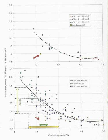
Zusammenhang zwischen Entmischungs- und Verdichtungsmass eines Nationalstrassenabschnitts in den Vorversuchen (oben) und während der Bauzeit (unten)
