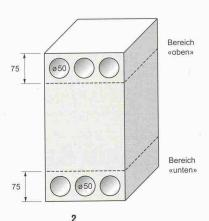
Entnahmepositionen der Bohrkerne ( $\emptyset = H = 50 \text{ mm}$ ) aus den Prüfkörpern
