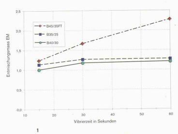
Entmischungsmass in Funktion der Vibrierzeit für die drei Betonmischungen (Bilder: Empa)
