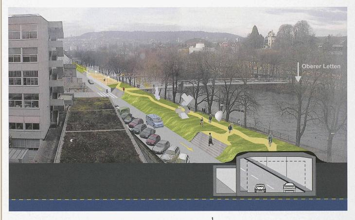
Sihlquai Zürich: Ein normal dimensionierter Tunnel würde das Sihlquai bis zu 3 m überragen und wäre politisch nicht durchsetzbar. Die hartnäckige Forderung nach Minimierung des Tunnelquerschnitts zeigte, dass eine städtebaulich interessante und vertretbare Tieflegung möglich ist (Bilder: Güller Güller)
