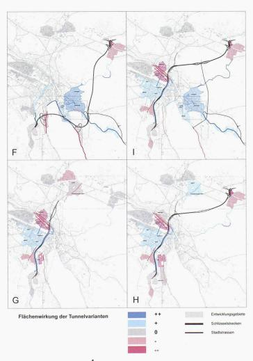
Flächenwirkung Seetunnel / Stadttunnel: Die Flächen- und Tiefenwirkungskarten der verschiedenen Netzvarianten zeigen den stark variierenden Einfluss der Lösungsvorschläge auf das Stadtgebiet
