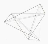
Die erste Elementarzelle des von R. B. Fuller entwickelten Tensegrity-Systems ohne Kontakt zwischen den Druckstäben (Bilder: Wenn nicht anders angegeben: Passera & Pedretti)
