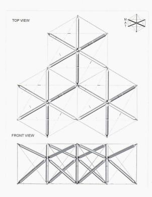
5 und 6 Elementarzelle des Tensegrity-Systems mit Zentralknoten Geometrisch steife Verbindung von Zellen in Bild 5 mit zusammenhängenden Druckstäben
