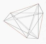
Geometrisch steife, aus der flexiblen Zelle in Bild 1 durch die Einführung von 3 zusätzlichen äusseren Kabeln entwickelte Elementarzelle
