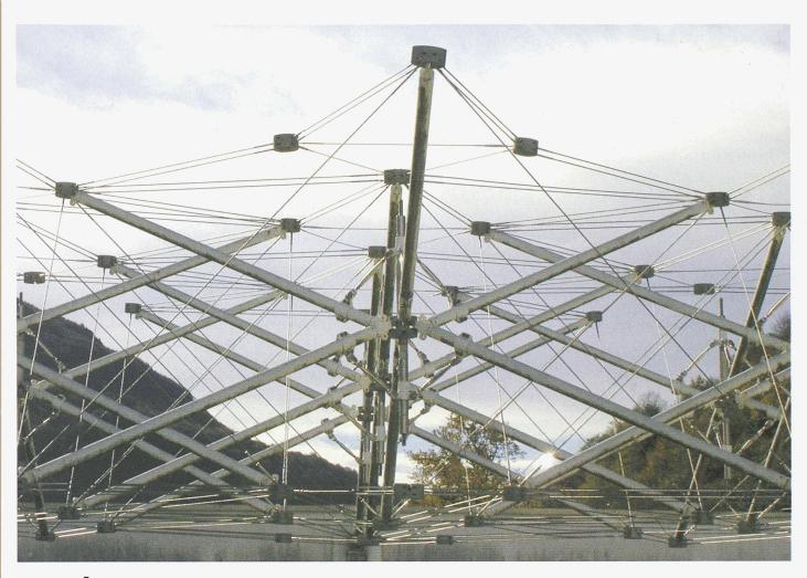
7 Modellanordnung eines räumlichen Tragwerks für die Untersuchung des Verhaltens von Elementarzellen mit Zentralknoten
