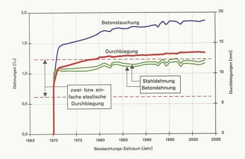
Zeit-Verformungs-Diagramm des Langzeitversuchs 1970 bis 2002 (Belastung 2 F =  $2 \times 30$  kN)
