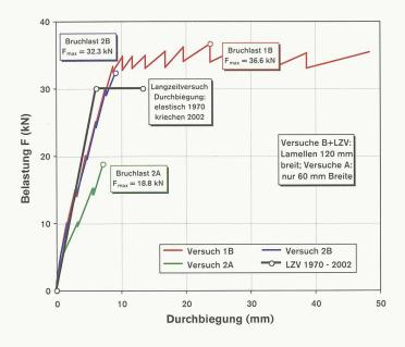
Last-Verformungs-Diagramm von statischen Belastungsversuchen unter Einbezug der Ergebnisse des Langzeitversuchs (LZV) der Jahre 1970 bis 2002 (effektive Trägerbelastung immer 2 F)
