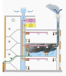
Überschreitung einer zulässigen Rauchkonzentration schliesst das Rauchmeldesystem automatisch. Die Rauchabführung erfolgt über die Fortluftleitung ins Freie. Bei Raumtemperaturen über 72 Grad Celsius schliessen auch die Brandschutzklappen in den Zu- und Abluftleitungen und sichern dadurch den baulichen Brandschutz.
