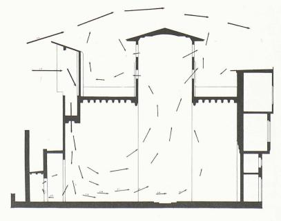
Die natürliche Belüftung des Hauses Muhibb Al-Din Muwaggi in Kairo. Ein Turm auf dem Hausdach fängt frische Luft ein und leitet diese hinunter in den Hof (Bild: Omar el-Farouk)
