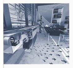
Mit der dezentralen Fassaden-System-Lüftung von Trox Hesco sind von einfachen Zuluftgeräten bis zu komplexen Zu-/Abluftsystemen vielfältige Varianten realisierbar. Für Gebäude mit raumhoch verglasten Aussenwänden ist der Einsatz von Unterflurgeräten die ideale Lösung. Die Lufteinbringung erfolgt durch Quellluftdurchlässe im Fussboden.
