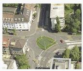
Die Lärmreduktion durch den Kreisel an der Basler Dorenbachkreuzung entspricht einer Verkehrsreduktion um 40 % (Bilder; pd)
