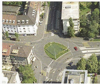
Die Lärmreduktion durch den Kreisels an der Basler Dorenbachkreuzung entspricht einer Verkehrsreduktion um 40 % (Bilder: pd)
