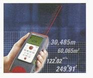
Direkttaste erledigt wird, bietet der «classic 5» neben der Soft-Touch-Tastatur einen eingebauten Fernrohrsucher für berührungsloses Messen auf längere Distanzen. Erweiterte Möglichkeiten der Messdatenspeicherung bis hin zu indirekten Höhenbestimmungen und Absteckungen (Tracking) ergänzen das Programm. Die Geräte sind im Fachhandel erhältlich.
