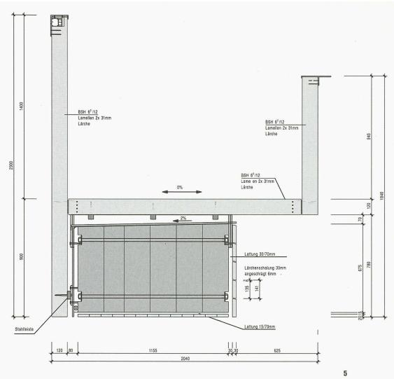
Brückenquerschnitt. Am rundum witterungsgeschützten Paket der Tragbalken sind mittels Stahlteilen die Geländer und der Gehbelag (alle aus einheitlich dimensionierten Lärchenlatten) befestigt. Die Asymmetrie nimmt Bezug auf die Situation mit unterschiedlichen Beziehungen und Ausblicken (Plan Projektverfasser, Mst. 1:20)
