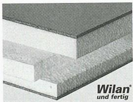
Isolationselemente **beidseitig** belegt mit schlagfesten und hochdruckreinigerfesten Deckschichten, z.B. aus weissbeschichteten Dünnspan- oder Kunststoffplatten. Einfache, problemlose Montage auf Holz-Unterkonstruktionen, Stahlkonstruktionen, usw.
