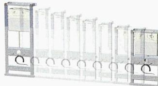
abgestimmt ist neben den Systemteilen auch das WC-Element. Dank praktischem Zoom-Effekt lässt es sich in der Einbauhöhe stufenlos von 82 bis 112 cm verstetzen. Für alle Einsatzbereiche und unterschiedlichen Einbauhöhen ist nur mehr ein WC-Element erforderlich. Flexibel nach oben oder unten mitzoomen lässt sich auch das Spülrohr, das je nach Anforderung vom Installateur ganz leicht in 5-Millimeter-Schritten auf das gewünschte Mass gekürzt werden kann.
