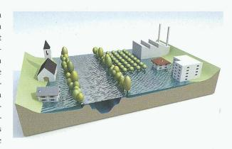
1-3 Die eingeengte Rhone im jetzigen Zustand (Bild 1). Bei Hochwasser überschwemmt sie wahllos beide Talseiten (Bilder 2 und 3; Bilder: Dienststelle für Strassen- und Flussbau des Kantons Wallis)
