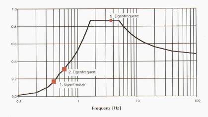
Bemessungsspektrum für die Baugrundklasse C und einen Verhaltensbeiwert von q=2.0 bei einer maximalen Bodenbeschleunigung von  $a_{nd}=0.6$  m/s<sup>2</sup>
