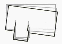
Verschiebung der Decke des 12. Obergeschosses in der 1. (links) und 2. Eigenform
