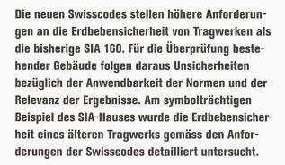
Eine erste Abschätzung zur Erdbebensicherheit des SIA-Hauses in Zürich führte zum Ergebnis, dass das Tragwerk den Anforderungen der neuen Swisscodes<sup>1,2</sup> wahrscheinlich nicht genügt. Die daraufhin angeordnete detaillierte Überprüfung der Erdbebensicherheit wurde zwischen Dezember 2002 und März 2003 durchgeführt und umfasste im Wesentlichen die folgenden Schritte:
