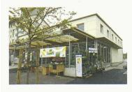
Die Landi in Gipf-Oberfrick AG ist die erste Landi-Verkaufszentrale mit dem Minergie-Label. Die Fassadenverkleidung besteht aus einer hinterlüfteten Faserzement-Platte. Das extensiv begrünte Flachdach wurde als Warmdach ausgebildet und
