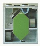
Die neue Gerätegeneration KWLEC 300 von Helios verfügt über ec-Motoren (Gleichstrom) und einen Kreuz-Gegenstrom-Wärmetauscher. Ebenfalls ist eine automatische Bypassklappe für den Sommerbetrieb im Gerät eingebaut. Neu sind CO<sub>2</sub>- und Feuchtefühler im Angebot. Sind mehrere Personen im Haus oder in der Wohnung, so nimmt die CO<sub>2</sub>-Konzentration zu. Misst nun ein Fühler den
