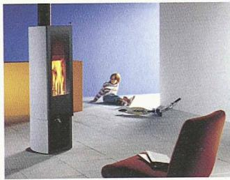
Speicheröfen der Tonwerk Lausen AG sind auf die Bedürfnisse gut isolierter Bausubstanz ausgerichtet: Sie haben eine tiefe Wärmeabgabeleistung während des Abbrandes und liefern langanhaltende Strahlungswärme während 6 bis über 12 Stunden.
