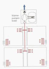
System eignet sich aber auch für die Minergie-Sanierung bestehender Mehrfamilienhäuser. Am Ende des Abluftrohres steht dann eine Wärmepumpe, welche die Wärme über einen Wärmeträgerkreislauf zum Boiler transportiert. *Trivent AG*, FL-9497 Triesenberg, +423 265 42 42, Fax +423 265 42 52, www.trivent.com.
