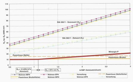
Vergleich von Standards auf der Basis des Heizwärmebedarfes nach SIA 380/1 (Bild: Reto von Euw, Zertifizierungsstelle Minergie-P)
