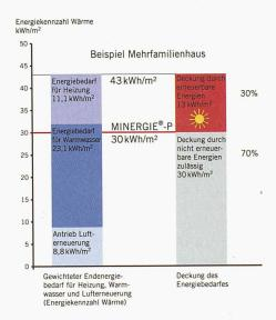
Gewichtete Energiekennzahl Wärme (Bild: Minergie)
