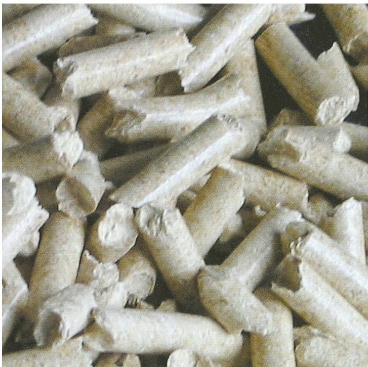
Pellets bestehen aus gepresstem Sägemehl und Hobelspänen und sind etwa fingergröss. Eine Holzfeuerungsanlage mit Pellets ist ähnlich leicht zu bedienen wie eine Ölfeuerung (Bild: Holzenergie Schweiz)
