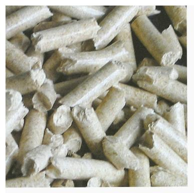
Pellets bestehen aus gepresstem Sägemehl und Hobelspänen und sind etwa fingergross. Eine Holzfeuerungsanlage mit Pellets ist ähnlich leicht zu bedienen wie eine Ölfeuerung (Bild: Holzenergie Schweiz)
