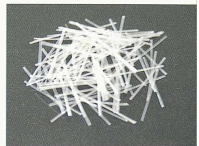
Polymerfasern aus Polyvinylalkohol, Durchmesser 0,05 mm, Länge 6 mm und E-Modul 40 000 N/mm 2
