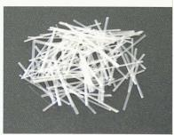
7 Polymerfasern aus Polyvinylalkohol, Durchmesser 0,05 mm, Länge 6 mm und E-Modul 40 000 N/mm²
