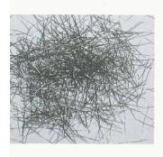
Vikrostahlfasern mit einem Durchnesser von 0,2 mm, einer Länge von 12 mm und einer Zugfestigkeit von 2000 N/mm²
