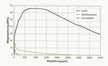
2 Vergleich der Biegezugspannung-Rissöffnungsdiagramme von Normalbeton, Stahlfaserbeton und faserverstärktem UHPC
