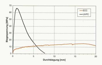
Typische Biegezugspannungs-Durchbiegungsdiagramme von ECC und UHPC
