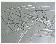
5 Mikrostahlfasern mit einem Durchmesser von 0,6 mm, einer Länge von 30 mm und einer Zugfestigkeit von 1100 N/mm²
