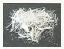
6 Polymerfasern aus Polyvinylalkohol mit einem Durchmesser von 0,2 mm, einer Länge von 12 mm und einem E-Modul von 30 000 N/mm²
