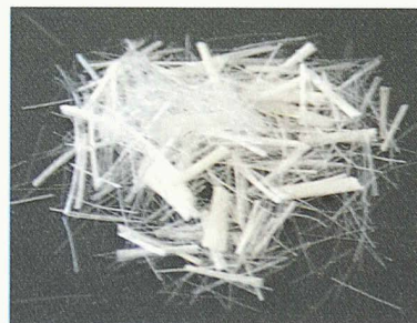
Polymerfasern aus Polyvinylalkohol mit einem Durchmesser von 0,2 mm, einer Länge von 12 mm und einem E-Modul von 30 000 N/mm 2
