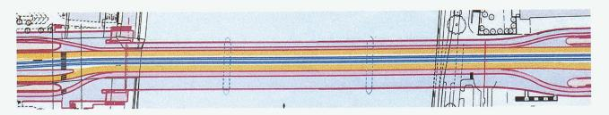
Die weitgehend identischen Zwillingsbrücken wirken als Durchlaufträger über drei Felder mit Spannweiten von 77,105 und 84 m. Die Fahrbahnplatten sind durch ein vertikales Strebenfachwerk mit ausbetonierten Stahlhohlkasten von  $40 \times 40$  cm als sichtbare Diagonalen verbunden. Quer vorgespannte Rippenplatten mit einer Spannweite von ca. 15 m zwischen längs vorgespannten Betongurten tragen die Fahrbahnen. Die Gesamtbreite misst 33 m, und die konstante Bauhöhe
