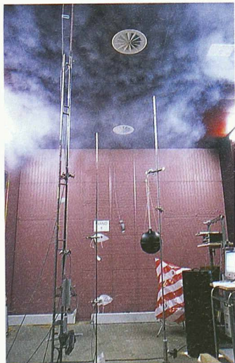
Rauchversuch in der Raumklimakammer (Bild: HTA Luzern)
