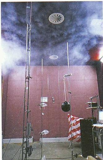
Rauchversuch in der Raumklimakammer (Bild: HTA Luzern)
