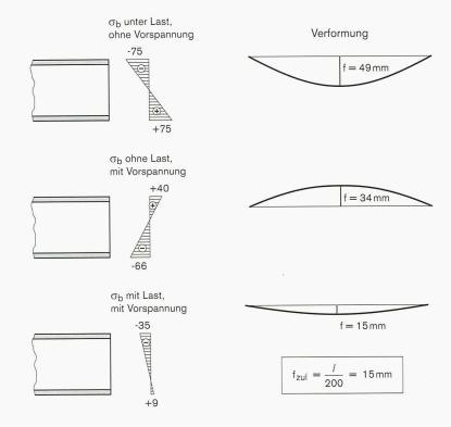
Verhalten eines GFK-Biegeträgers mit einer Einzellast und einer geregelten Vorspannung (Bild: Empa Dübendorf)
