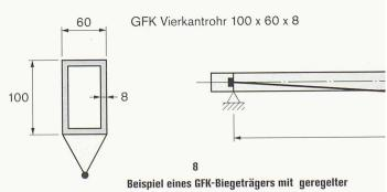
Beispiel eines GFK-Biegeträgers mit geregelter Vorspannung (Bild: Empa Dübendorf)
