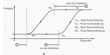
Schematisches Hystereseverhalten bei den Phasenumwandlungen und Gebrauchstemperaturbereiche Nr. 1 und 2 für verschiedene Anwendungszwecke (Bild: Empa Dübendorf)
